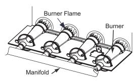
Fig. 63 – Burner Flame
